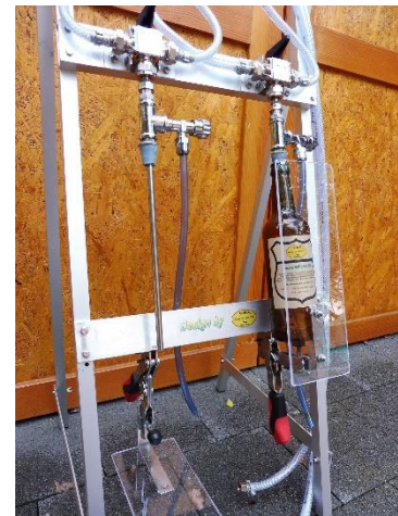
Abbildung 8: Selbstgebauter Gegendruckabfüller von Herrn Bösigger
